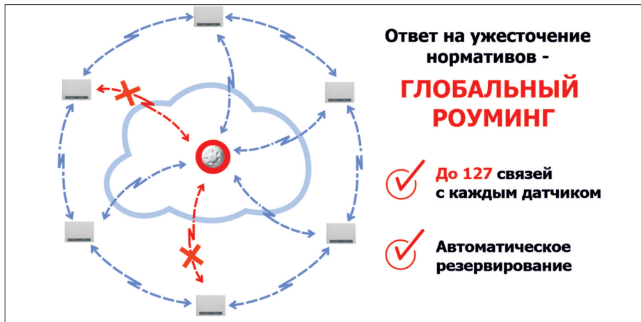
Рис. 2. Реализация требования по "единичной неисправности" с использованием радиосистем с глобальным роумингом
