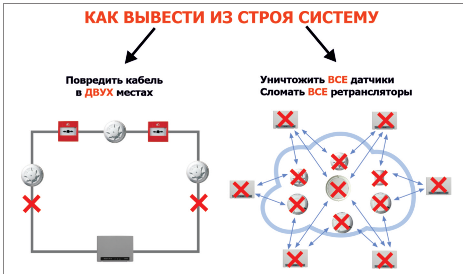
Рис. 3. Сравнение надежности проводной и беспроводной систем
